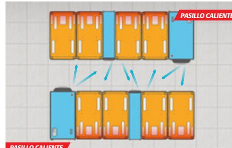
Al colocar las unidades del Liebert CRV de 600mm en cualquiera de los extremos de las filas e insertar unidades de 300mm en el medio, el control Liebert iCOM garantiza que el pasillo está presurizado de manera uniforme y así simulando la contención del pasillo frío.
