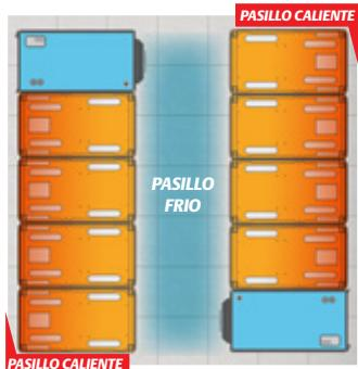
Para los centros de datos en los que se debe aumentar la densidad del calor sin instalar un piso elevado o un techo más alto, el Liebert CRV y el confinamiento de pasillos SmartAisle™ de Emerson Network Power es la solución ideal.
